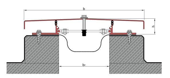
SEISMIC RESISTANT EXPANSION JOINT SOLUTIONS
