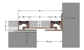
SEISMIC RESISTANT EXPANSION JOINT SOLUTIONS
