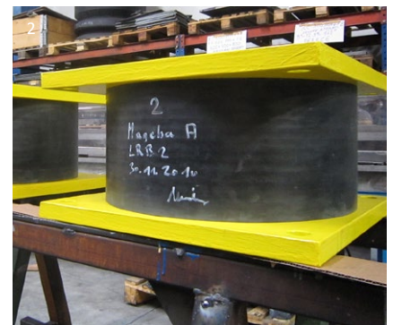
1 Essai sur des appuis LASTO®LRB 2 Fabrication d'un appui LASTO®LRB
