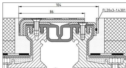
Joint installé avec plaque antidérapante
