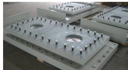
DISK bearings (mit doppelten DISKS pro Lager) bereit für die Auslieferung
