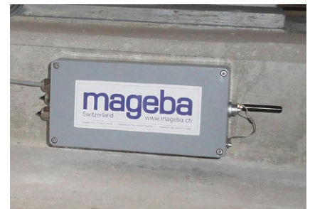
Datenerfassungseinheit eines SHM-System
