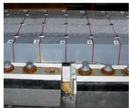
Bewegungskapazitätstest an einem Prüfkörper des Typs PA 50 TENSA®POLYFLEX®Advanced PU
