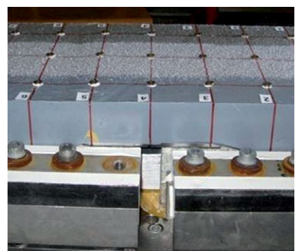
TENSA®POLYFLEX®Advanced PU 树脂填充式伸缩缝变形量试验
