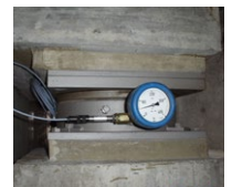
Zvedací a měřicí ložiska
