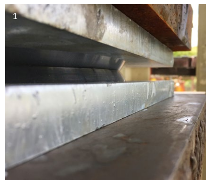
1 Ensayo de apoyo de disco a 150 % de la carga de diseño de acuerdo a norma AASHTO LRFD.
