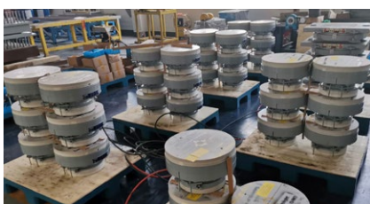
Apoyos Esféricos con abrazaderas para fuerzas de levantamientos no frecuentes
