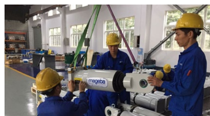
Etiquetado de amortiguadores viscosos en la fábrica de mageba en Shanghái después de la fabricación
