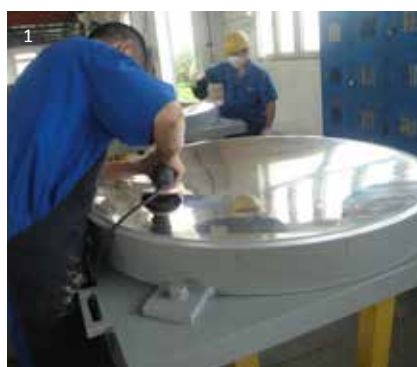
1 Traitement de surface d'un RESTON®PENDULUM
