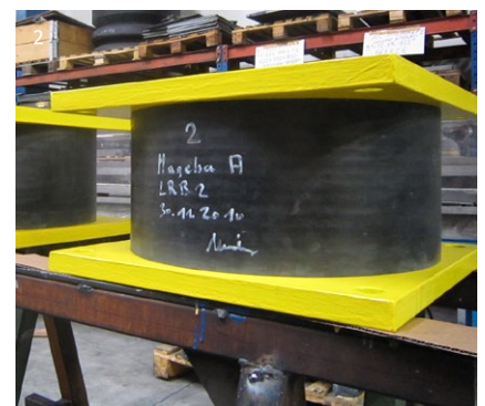
1 LASTO®LRB saru tesztelés közben
