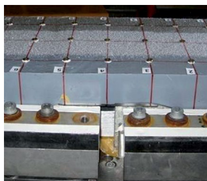
TENSA®POLYFLEX®ADVANCED PU a mozgáskapacitás vizsgálati tesztek alatt
