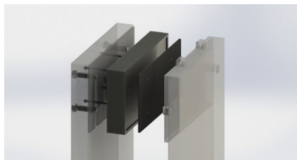
Vista 3D (despieces) de LASTO®BLOCK con superficie deslizante. Instalado verticalmente
