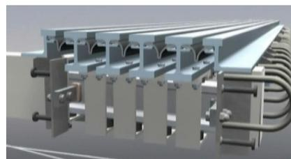
Las juntas Fuse-Boxes, se liberan de la losa en un sismo de manera controlada
