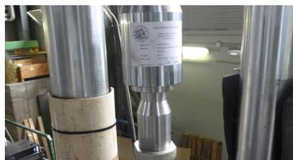
Un amortiguador, completamente montado con fusible, y listo para el transporte
