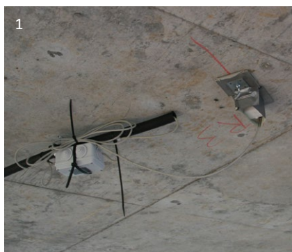
1 Sensor de aceleração 3D Medição de vibração Medição de temperatura Sensor de temperatura do concreto Sensor de Umidade Sensor de força do vento e de temperatura do ar Sensor de posição GPS
