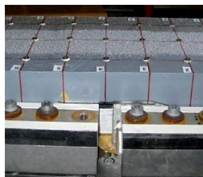
Test pohybovej kapacity na skúšobnej vzorke mostného záveru TENSA®POLYFLEX®Advanced PU
