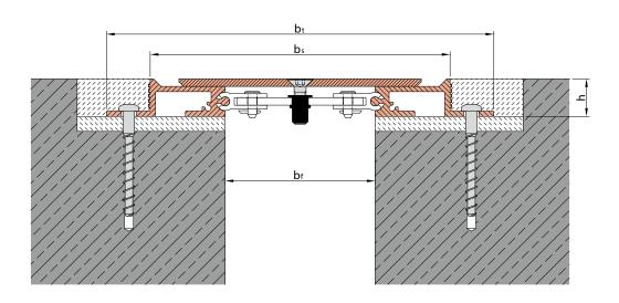
SEISMIC RESISTANT EXPANSION JOINT SOLUTIONS.
