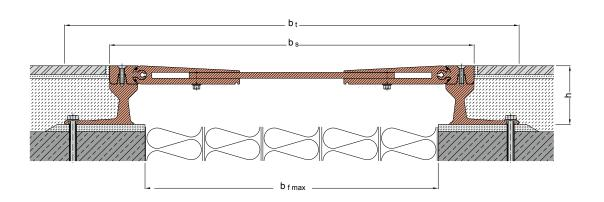
SEISMIC RESISTANT EXPANSION JOINT SOLUTIONS
