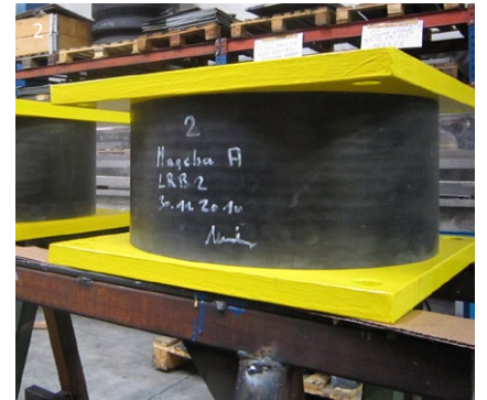
1 LASTO®LRB mesnetlerin test edilmesi 2 LASTO®LRB mesnetlerin imalatı
