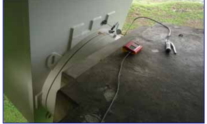
RESTON®SPHERICAL CONTROL kuvvet ölçüm mesnetleri Köprüye etki eden yükler, sürekli bir şekilde elektronik olarak izlenebilir.
